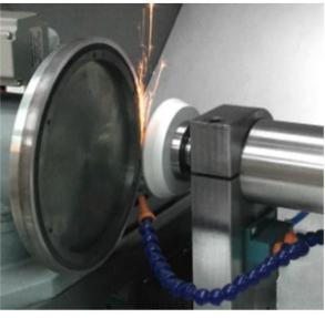
La nueva **ELITE modelo CC** permite el afilado automático de cuchillas circulares y contra-cuchillas de forma automática, ya sea en modo de afilado o bien en producción de series iguales, incorpora un sistema de control programable que mediante un eje CNC y dos ejes manuales permite una gran variedad de afilados.
